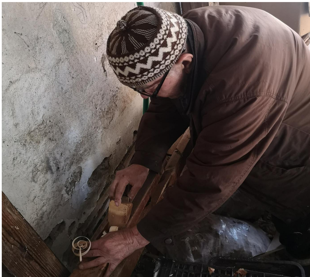
Slika 3. Šefik Gračić obrađuje duge na strugači uz pomoć šaramana (Snimio Vernes M.) / Image 3. Šefik Gračić is processing duge using strugača and šaraman (Photographed by Vernes M.)
